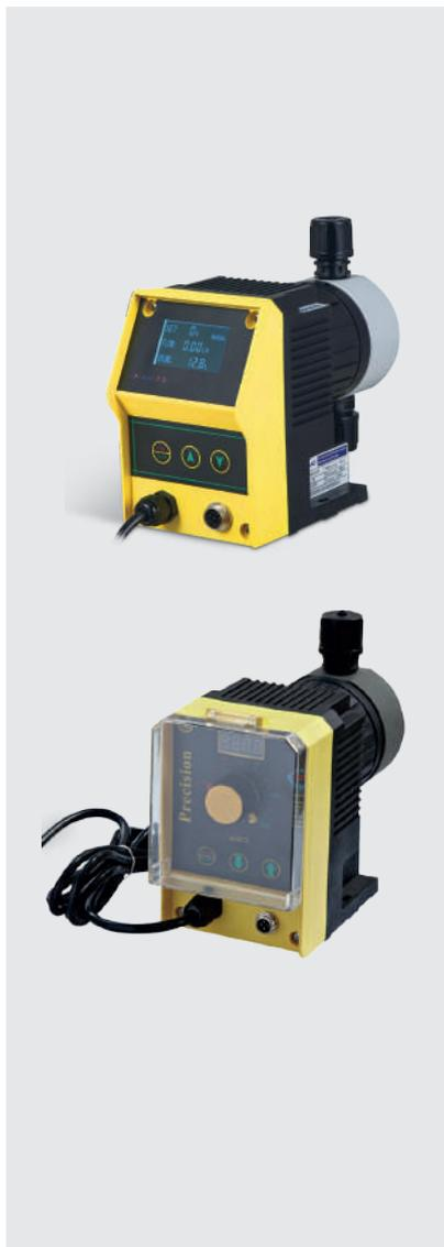
Соленоидные насосы мембранного типа также известны как электромагнитные дозирующие насосы. Сердцем соленоидного насоса является катушка индуктивности. Внутри нее движется шток или плунжер, соединенный с мембраной. Во время движения плунжера мембрана соответственно изгибается – изменяется объем рабочей камеры
