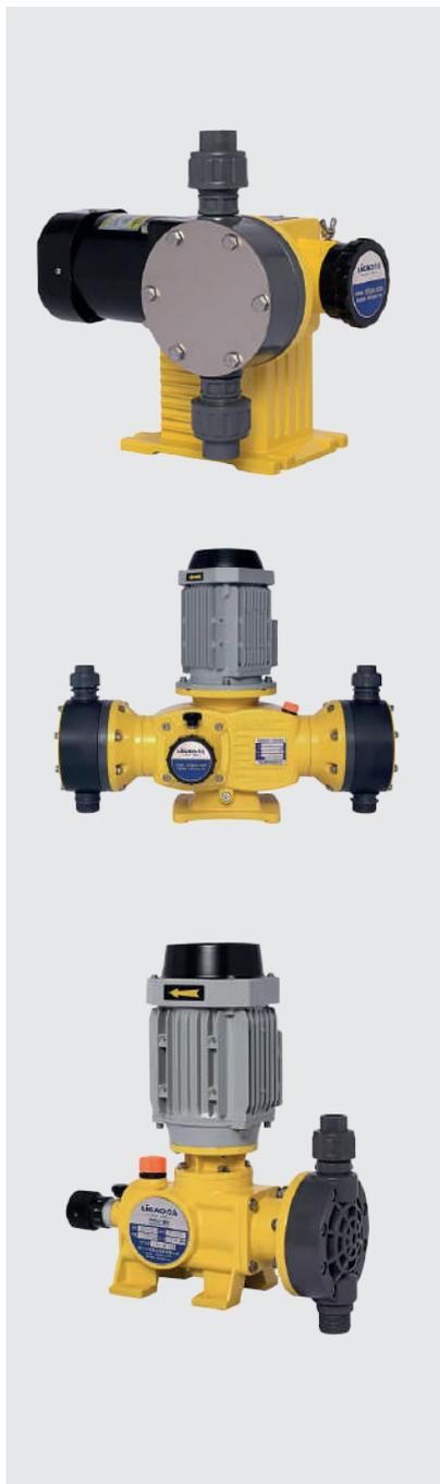
Механические дозирующие насосы – это мембранные насосы с асинхронным двигателем. Мембрана представляет собой пятислойную композитную диафрагму из PTFE с усиленной задней пластиной. Для изменения производительности можно менять как длину хода вала, так и частоту. Насосы этого ряда отличаются простой, надежной конструкцией и выгодной стоимостью, являясь примером, того как универсальное дозирование может сочетаться с минимальным техническим обслуживанием
